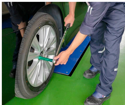
▲お客様により一層ご安心いただくために、トルクレンチ締め作業の確認を目視していただいております。
